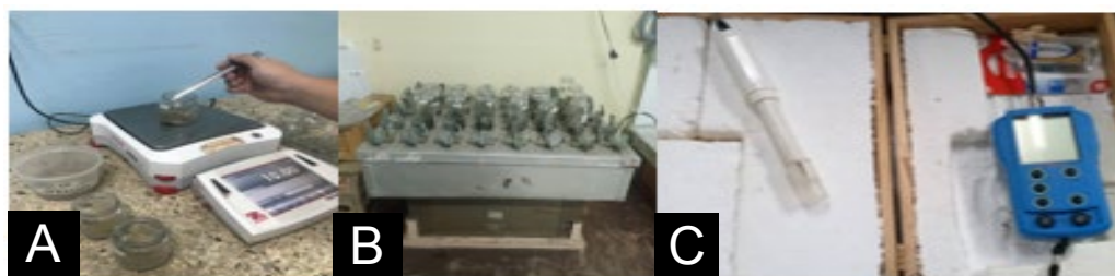
Figura 3. A) Peso de las muestras en balanza analítica. B) Agitación de las muestras. C) Medición y registro del valor de pH en la muestra.
