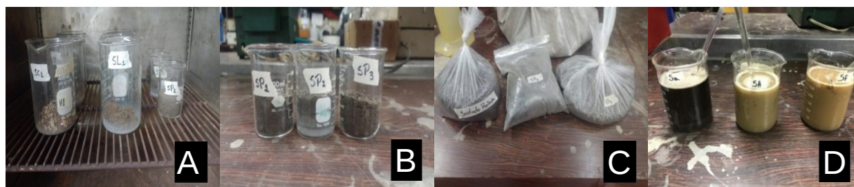
Figura 1. A) Beaker con 20 gramos de muestras de suelo dentro de la estufa. B) Beaker con 50 ml de muestras de sustrato. C) Muestras de suelos D) Beaker con mezcla de suelo, agua y solución dispersante.
