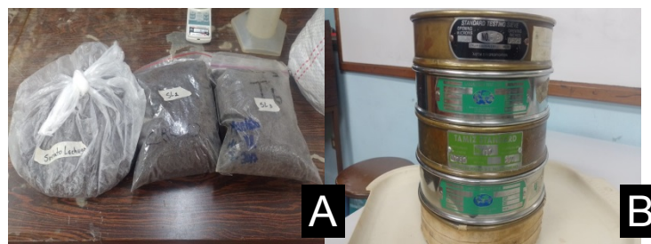
Figura 1. A) Muestras de sustratos B) Torre de tamices tamaños (16, 4, 2, 1) mm.
