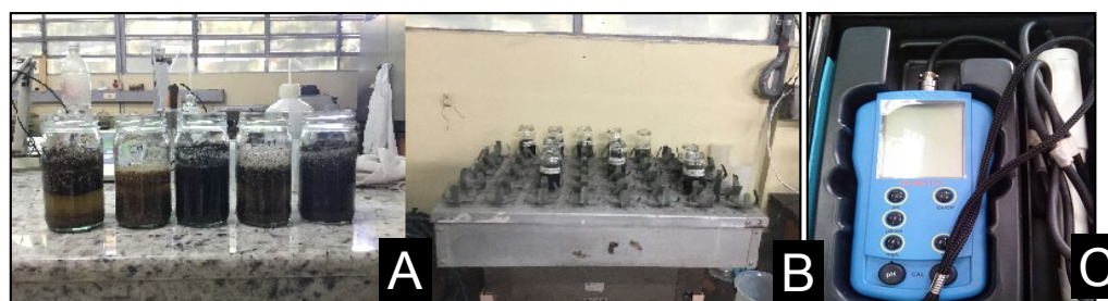
Figura 2. A) Envases con las mezclas de suelo-sustrato y agua destilada. B) Envases con las mezclas en el agitador. C) Equipo medidor CE (Hanna Hi 9811-5 portátil).
