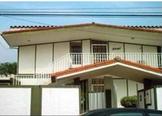
**Figura 11.** Viviendas unifamiliar y multifamiliar, Unidad Vecinal, San Cristóbal, sobresalen las líneas rectas y los elementos constructivos —columnas y losas— en las fachadas. Vivienda tipo quinta, resaltan los retiros de frente y laterales, el antejardín, la estructura de pórtico en concreto armado, losas nervadas planas —entrepiso— e inclinadas en cubierta con teja criolla. Fuente: Villanueva (2017, pp. 133 y 134).
