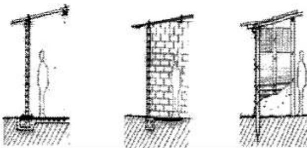
**Figura 18.** Secciones de viviendas que utilizan la cubierta de lámina liviana metálica con estructura metálica, muros simples con bloques trabados y horcones de madera. Fuente: Villanueva (2017, p. 184).
