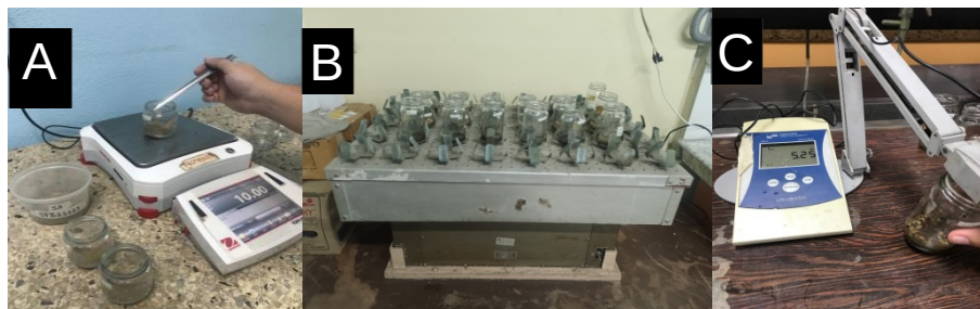
Figura 6. A) Pesaje de las muestras en balanza analítica. B) Agitación de las muestras. C y D) Medición y registro del valor de pH en la muestra.
