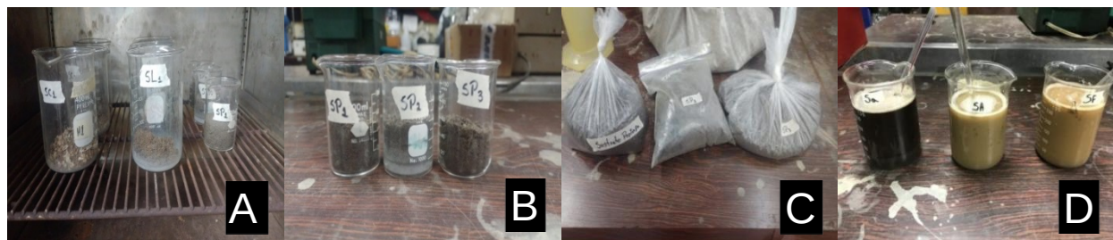
Figura 1. A) Beaker con 20 gramos de muestras de suelo dentro de la estufa. B) Beaker con 50 ml de muestras de sustrato. C) Muestras de suelos D) Beaker con mezcla de suelo, agua y solución dispersante.
