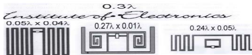
Figura 8. Ejemplos de Estructuras de Tag Miniaturizadas con Técnica de S rperntin Fuente: Marrocco.
