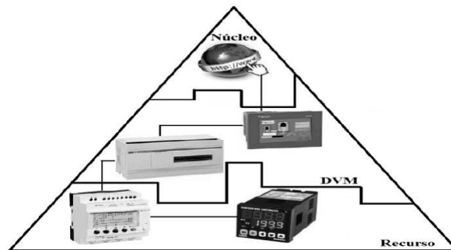
Figura 8. Arquitectura del Sistema de Control de Temperatura.
