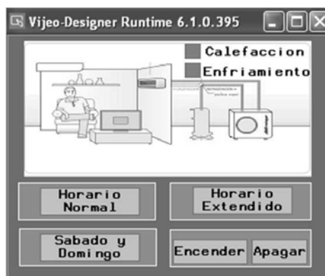
Figura 9. Interface (HMI) de Supervisión de Control de Temperatura.
