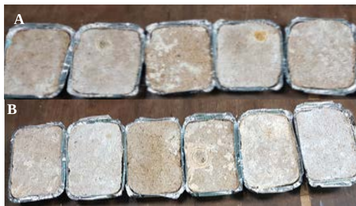
Figura 2. Aspecto de la conformación de los biomateriales en las bandejas de aluminio. A. Pasto (40) – bagazo (30) – cascarilla (20) – Aserrín (10). B. Bagazo de caña de azúcar (100).
