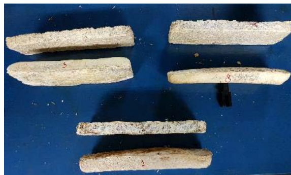
Figura 5. Apariencia lateral de los biomateriales que fueron sometidos a parámetros físicos y mecánicos para explorar su uso potencial como materiales de embalaje. Arriba: materiales con residuos molidos a 5 mm. Abajo: Materiales con residuos molidos a 1,5 cm.
