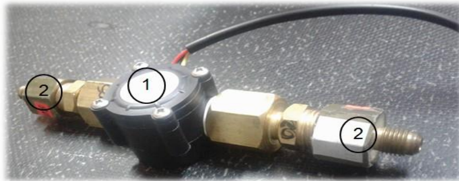
Figura 2. Ensamblado del sensor. 1) Sensor YF-S201, 2) reducciones roscadas de \frac{1}{4} de pulgada por \frac{1}{2} .
