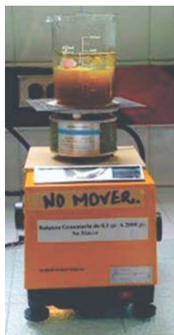
Figura 1. Equipo experimental para cálculo de temperaturas de ebullición y masa evaporada de jugo de caña.
