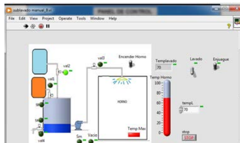
Figuras 13 y 14 Panel de control y monitoreo de variables del proceso etapa de Enjuague y Proceso del Horno en LabView etapa de enjuague
