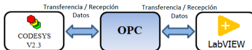
Figura 5. Diagrama de flujo del proceso de comunicación entre el software CoDeSys y LabView.
